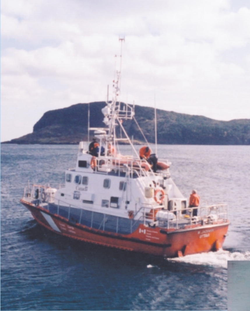
Un navire garde-côte de la classe ARUN de la GCC comme le W. Jackman permet une intervention rapide en opération de sauvetage et a un long rayon d'action.
