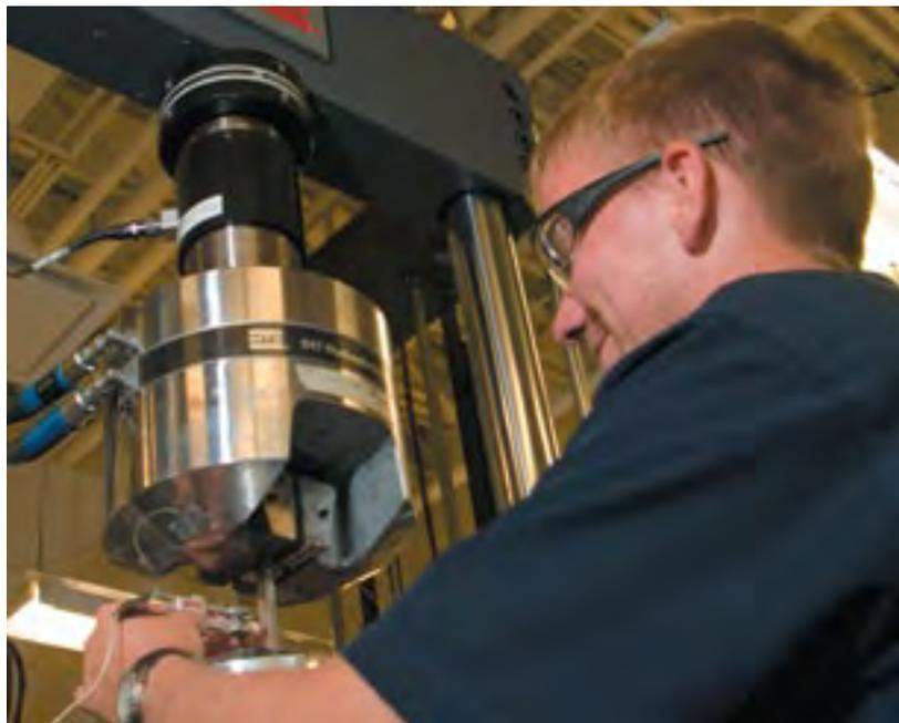
Le technicien en mécanique de RDDC, Tom Lemczyk, dirige une expérience pour déterminer les propriétés mécaniques d'un échantillon d'acier à l'aide d'un système d'essais mécanique servo-hydraulique.
