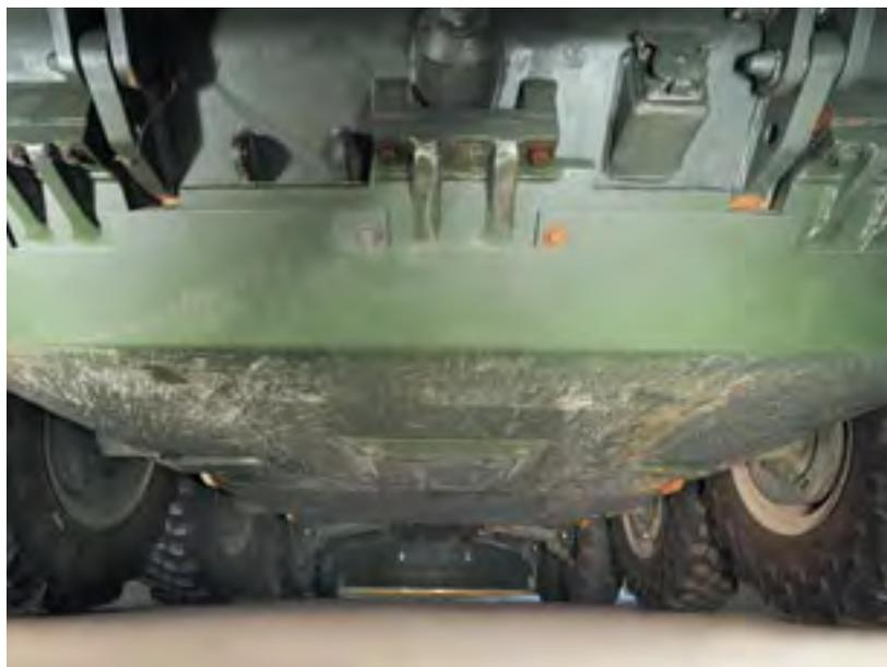
Gros plan de l'ensemble de blindage du dessous de coque du VBL III pour la protection contre les mines terrestres.
