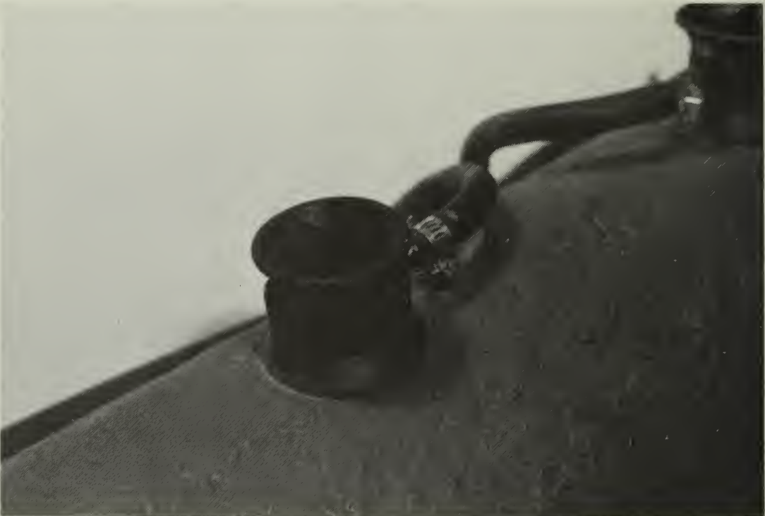
Fig. 16 Gros plan d'une conduite venturi d'un pulvérisateur pneumatique.
