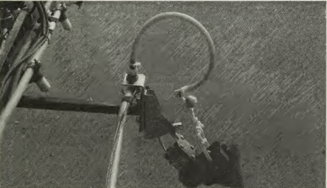
Fig. 14 Gros plan du disque rotatif entraîné par un moteur électrique.
