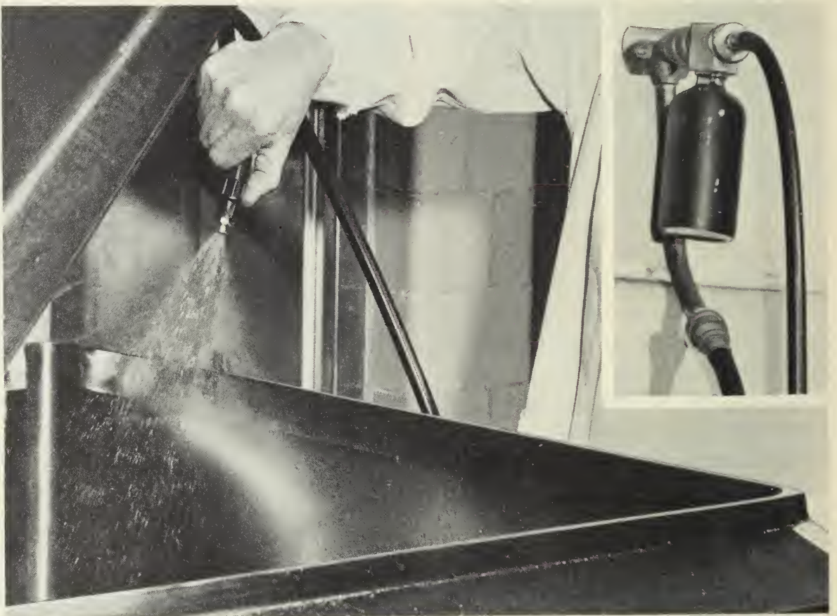
Illustration 7—Dispositif pour pulvériser la solution désinfectante sur les parois du réservoir de refroidissement.
