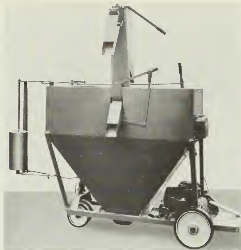
Figure 38 Chariot automoteur pour les aliments de la volaille
