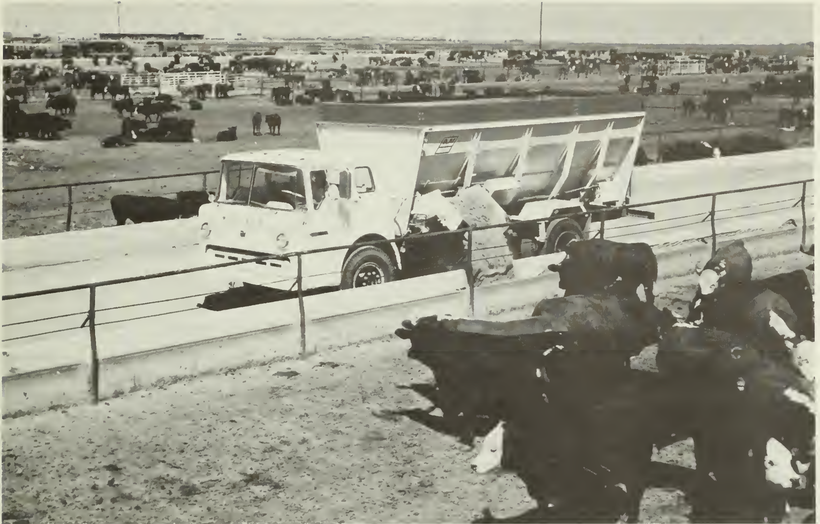
Figure 42 Distributrice pour mangeoire montée sur camion
