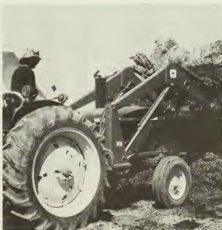
Figure 32 Chargeur frontal servant de désileuse de silo horizontal
