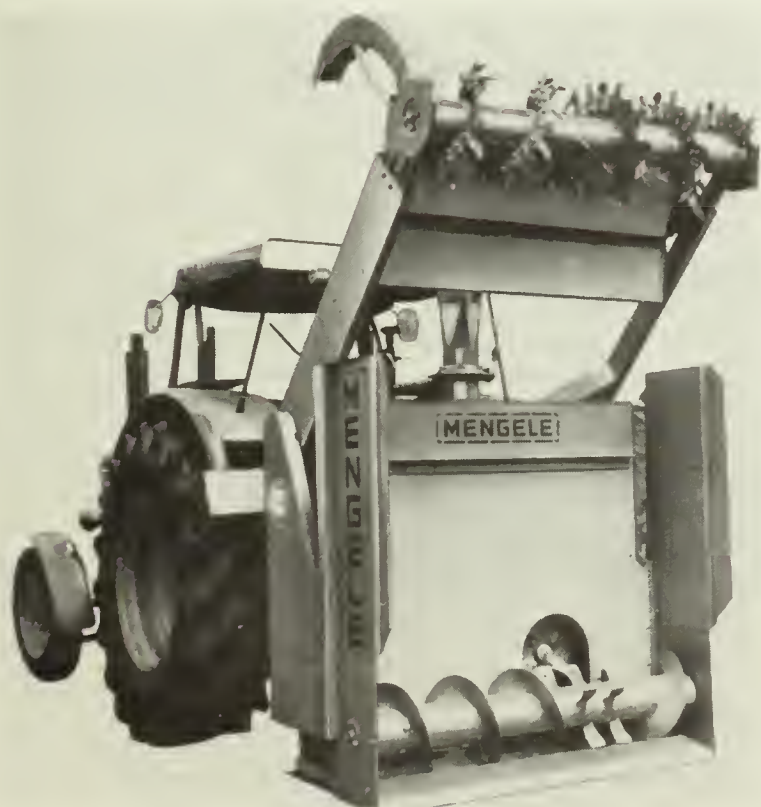
Figure 31 Désileuse de silo horizontal sur tracteur
