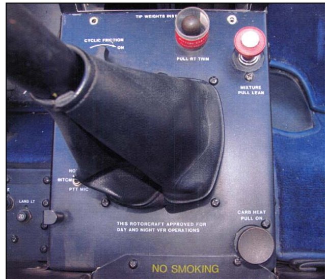
Photo 1. La console centrale montrant la commande de richesse dans le coin supérieur droit et la commande de réchauffage carburateur dans le coin inférieur droit
