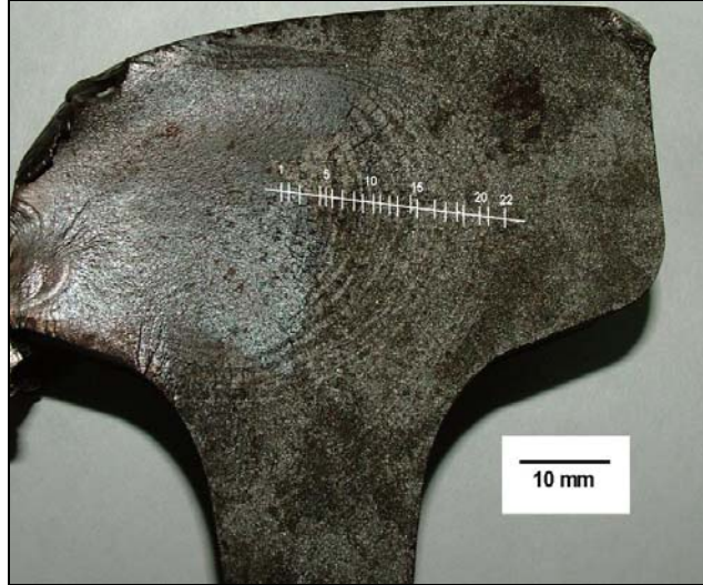
Photo 2b. Face de rupture A avec marques concentriques dans le secteur de la fissure de fatigue
