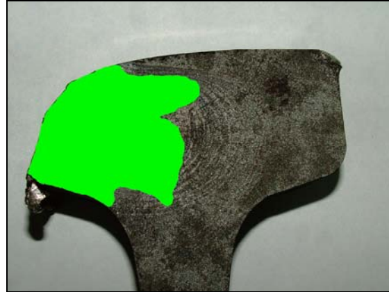
Photo 7. Zone polie affectée par la fatigue (en vert) par rapport à la surface de rupture A
