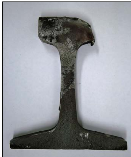
Photo 3. Face de rupture B
