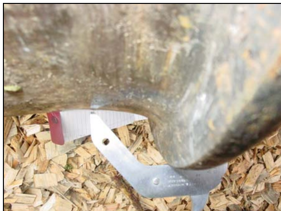
Photo 4. Boudin de roue trop haut sur un essieu monté
