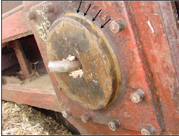
Photo 5. Pivot de caisse (bout B). Les flèches pointent vers le secteur affecté par l'usure
