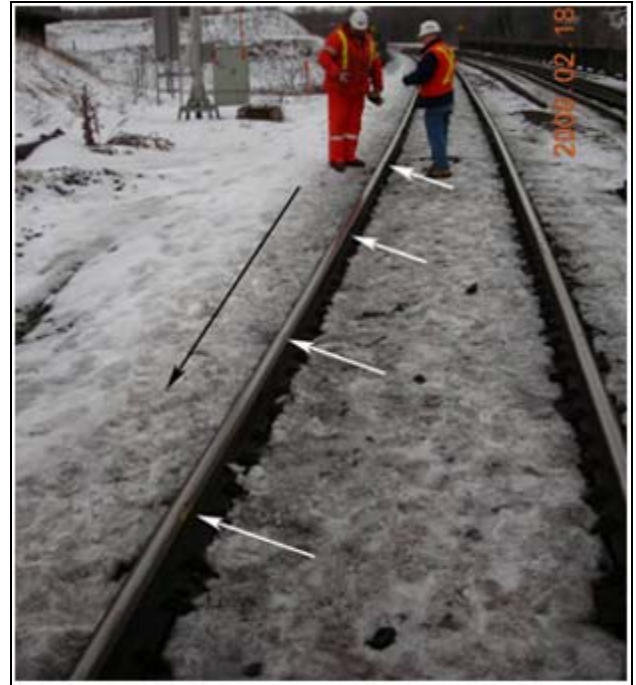
Photo 1b. Point milliaire 0,06 de la subdivision Dundas. La flèche noire correspond au sens d'avancement du train. Les flèches blanches pointent en direction des marques d'impact qu'on a relevées du côté intérieur du rail sud du tronçon sud de la voie.
