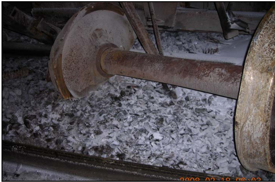
Photo 3. Essieu monté portant des roues à toile droite, dont une des roues est brisée, qu'on a retrouvé à l'endroit où des wagons avaient déraillé
