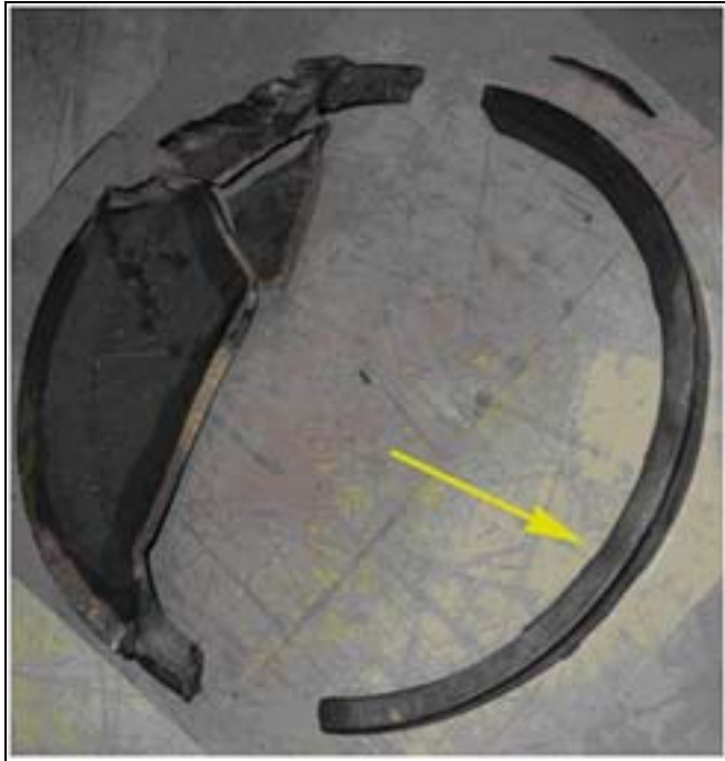
Photo 1a. La flèche jaune pointe vers le morceau de roue brisée qui a été récupéré au point milliaire 0,6 de la subdivision Dundas.
