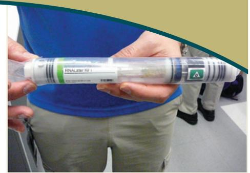
Tube développé au Kennedy Space Center pour permettre de fixer des échantillons d'organismes vivants en situation d'apesanteur. Source : RNCan
