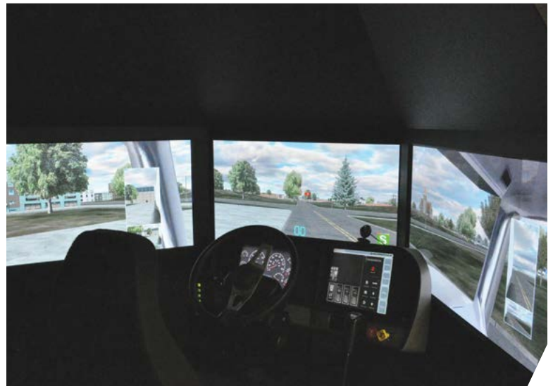
Simulateur de conduite à trois écrans
