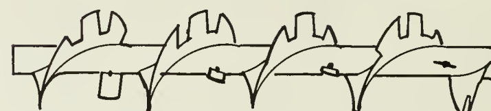
SPIRE TRCHANTE ET AILETTES Aération et mélange optimal des produits en mouvement
