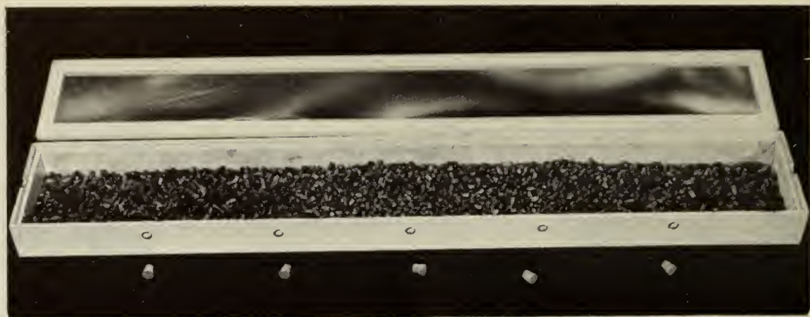
111. 5. -- Plateau d'incubation avec couvercle en polyéthylène transparent à 5 ouvertures de 1/2 pouce de diamètre. Les trous sont percés dans la partie latérale supérieure, ce qui empêche les cellules de tomber.
