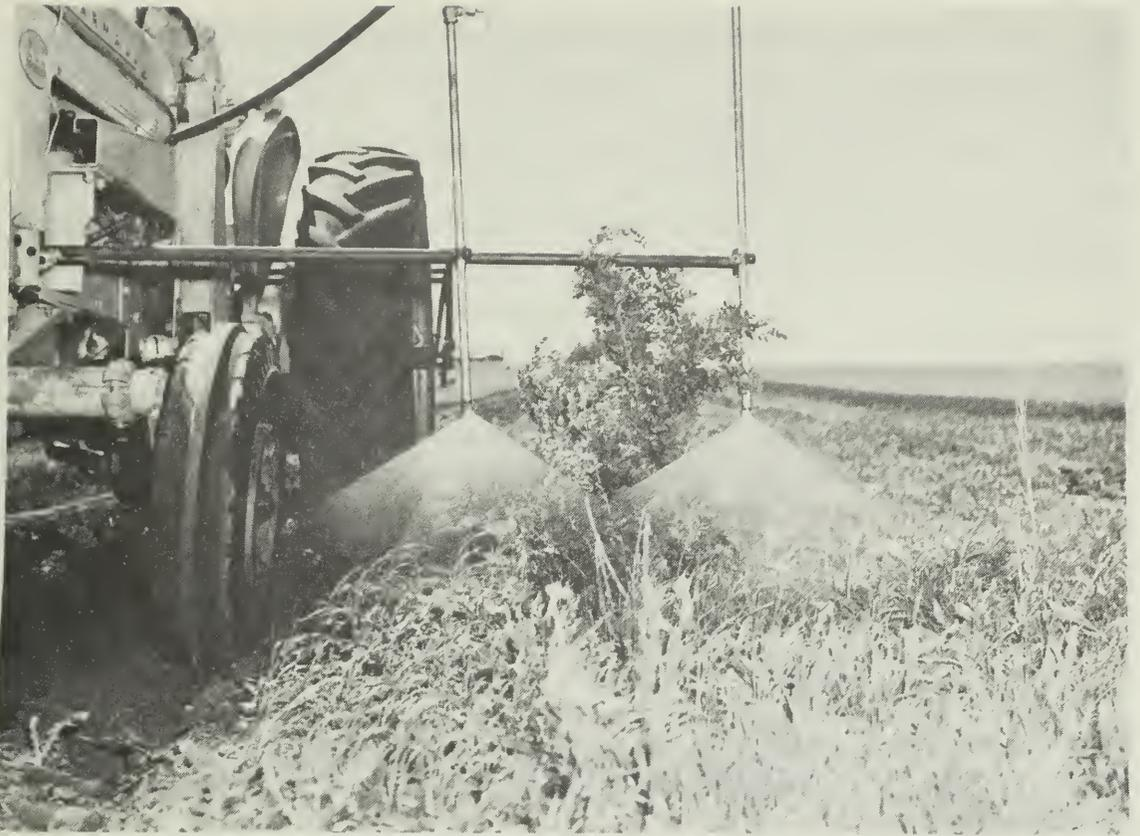
Rampe latérale spéciale, montée sur tracteur.
