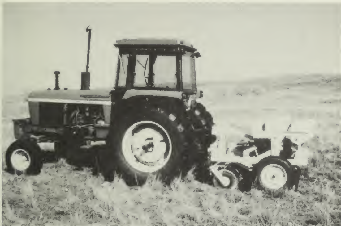
Fig. 6 Le semoir à grain Truax se prête à l'ensemencement des graminées et des légumineuses dans les parcours.
