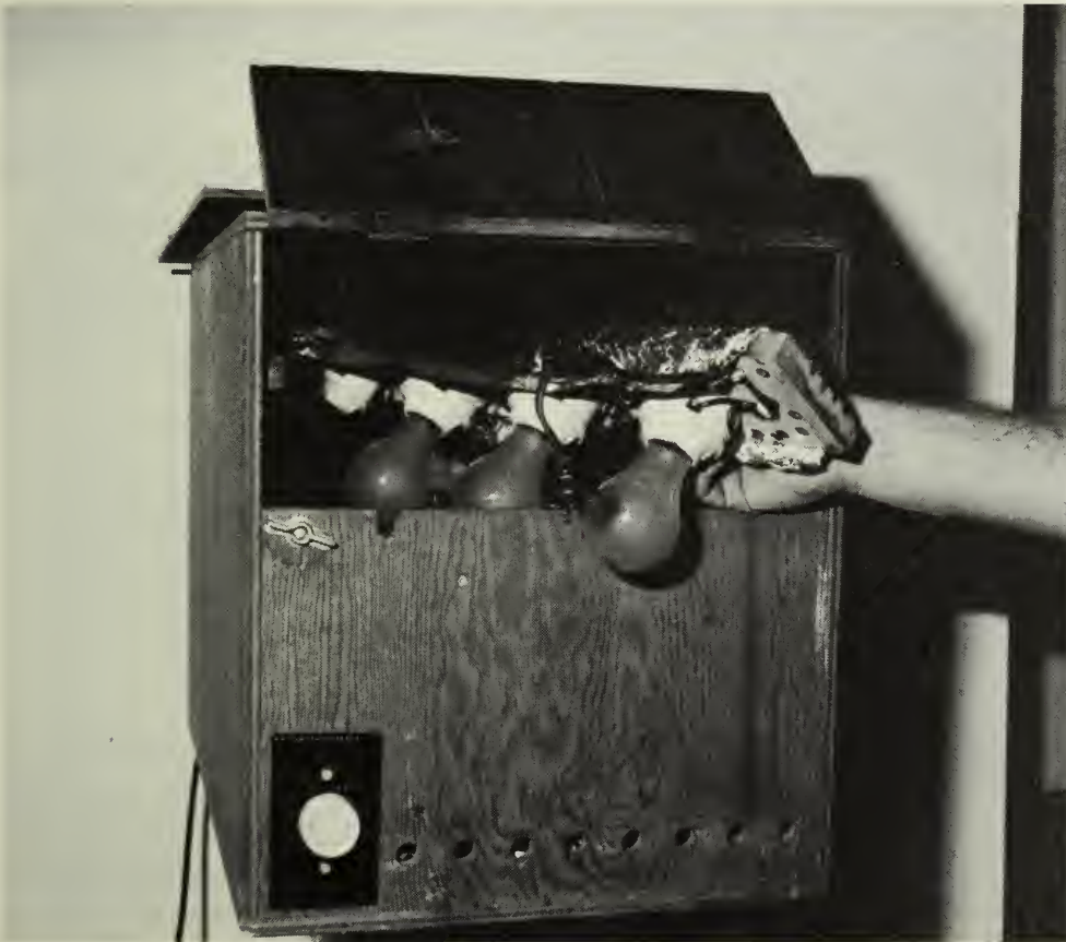
FIG. 11 Armoire de séchage de fabrication domestique munie d'ampoules en guise de source de chaleur ( voir la figure 12 pour les instructions de fabrication).
