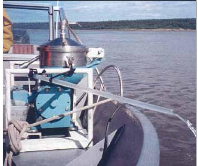
La centrifugeuse est un grand échantillonneur qui sépare l'eau de la rivière des sédiments en suspension. C'est un processus important, car la composition chimique de l'eau et des sédiments en suspension de la rivière Peel peut être très différente. Ils doivent être analysés séparément.
