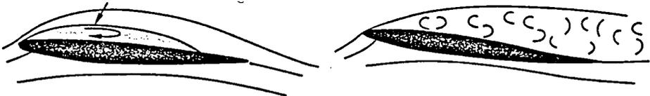
**CARACTÉRISTIQUES DE DÉCROCHAGE DES PROFILS D'AILES**
