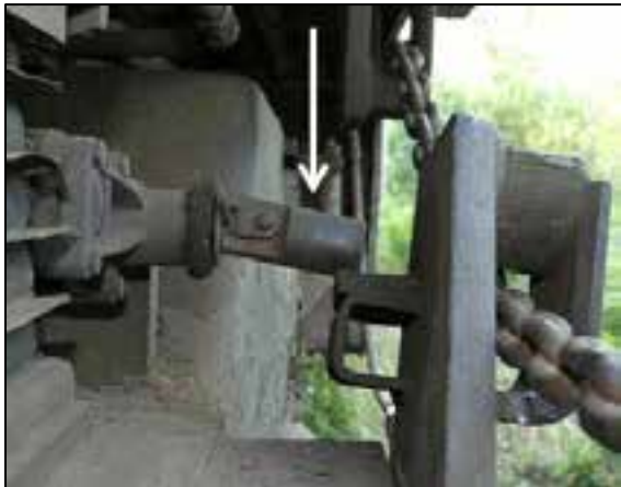
Photo 10. V.P.R. servant à évacuer l'air du cylindre de frein au cours du serrage du frein à main
