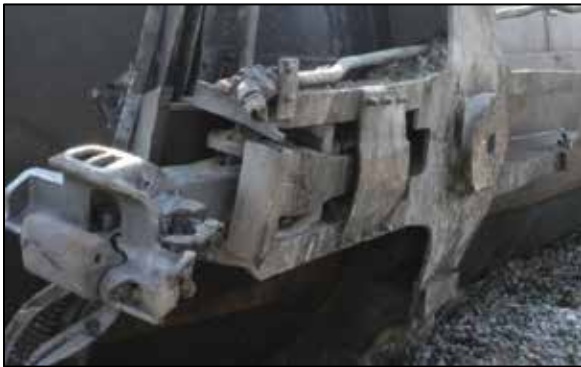
Photo 17. Longrine centrale tronquée complète
