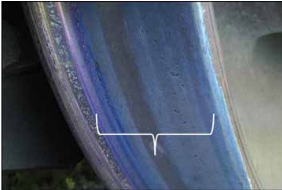
Photo 12. Bleuissage d'une roue de locomotive attribuable à la chaleur
