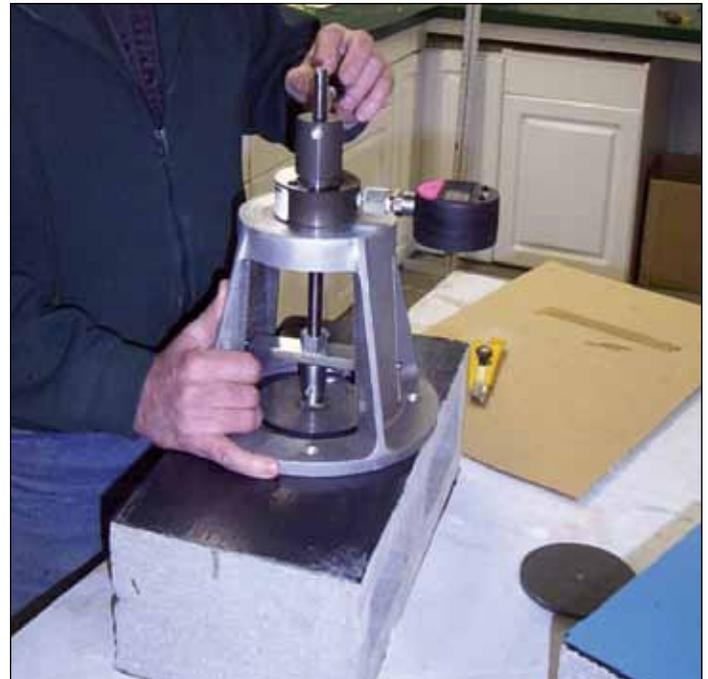
**Figure 1** Appareil numérique à commande manuelle appliquant une charge de tension au spécimen.
