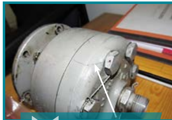
Fissure dans le boîtier de la pompe hydraulique causant une perte de liquide hydraulique
