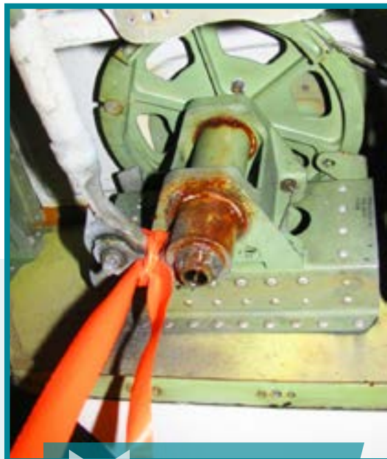
Sévère corrosion des paliers du secteur aileron
