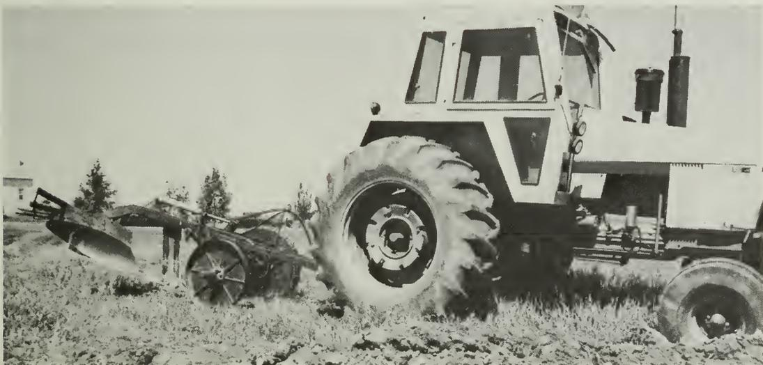
FIGURE 10. Charrue ordinaire modifiée et renforcée, pouvant labourer à une profondeur de 56 cm
