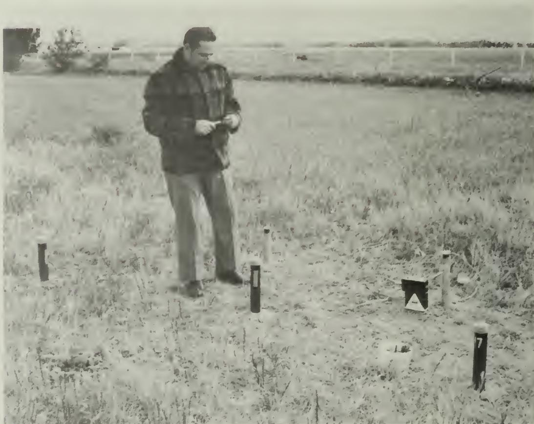
FIGURE 4. Batterie de piézomètres servant à mesurer la nappe phréatique à la sous-station à Vegreville.
