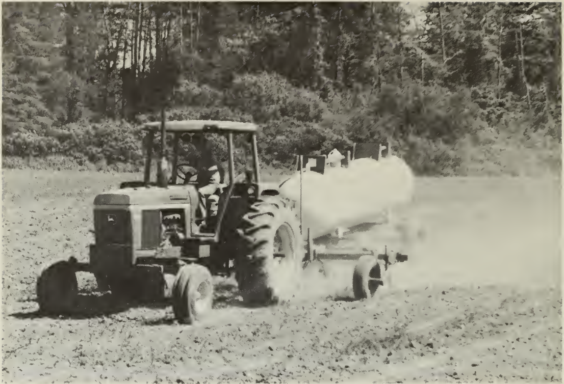
FIGURE 3: Application entre les rangs de maïs d'ammoniac anhydre par injection.
