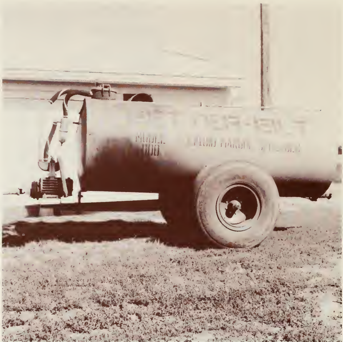
Figure 23. Citerne mobile munie d'une pompe à vide.
