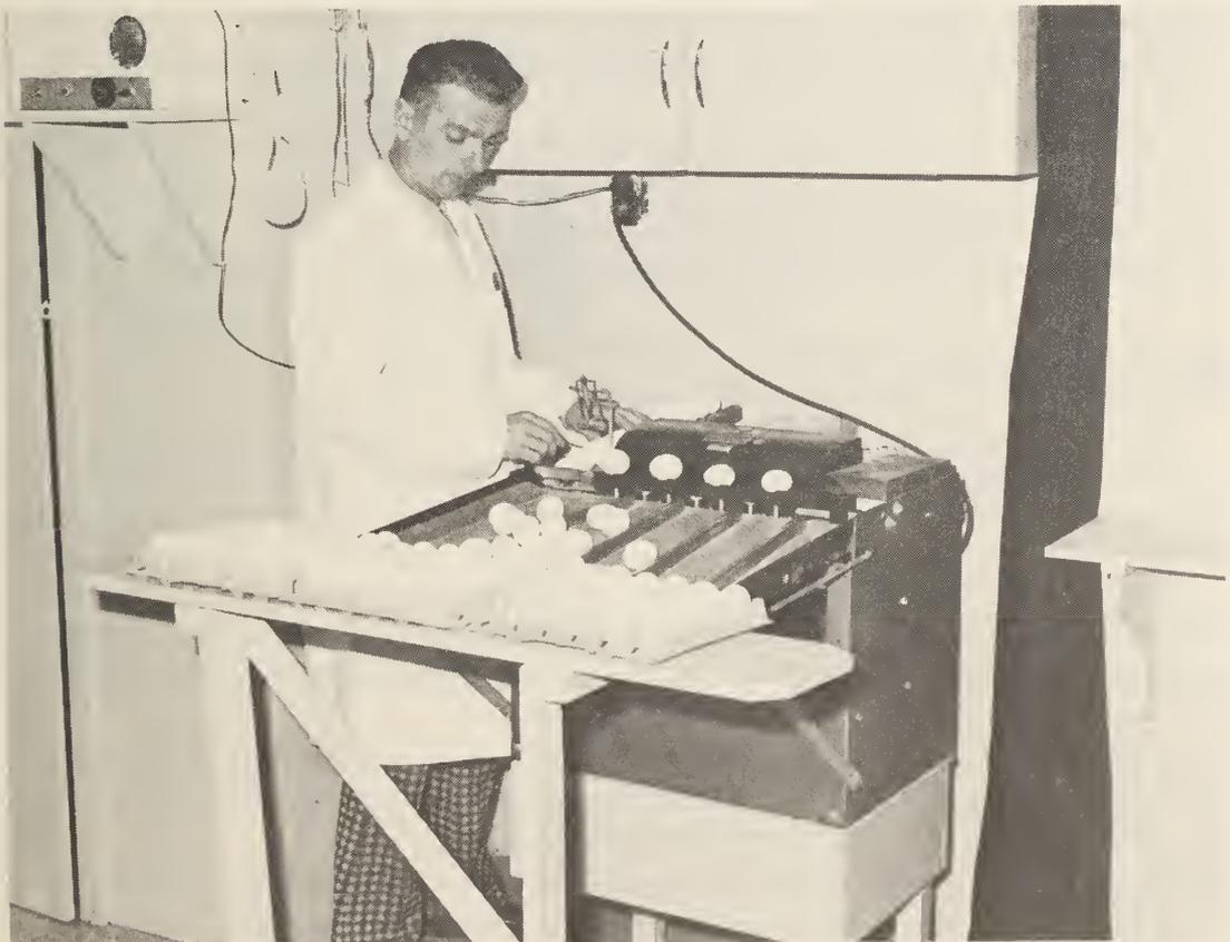
FIG. 11 Détermination du calibre pour éliminer les œufs trop petits et ceux à deux jaunes.
