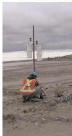
Travailleur vérifiant un appareil de surveillance de la qualité de l'air
