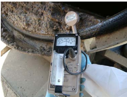
Radiamètre détectant la présence de matières radioactives naturelles dans la boue d'un camion aspirateur contaminé (Photo : courtoisie de Tervita Corporation)
