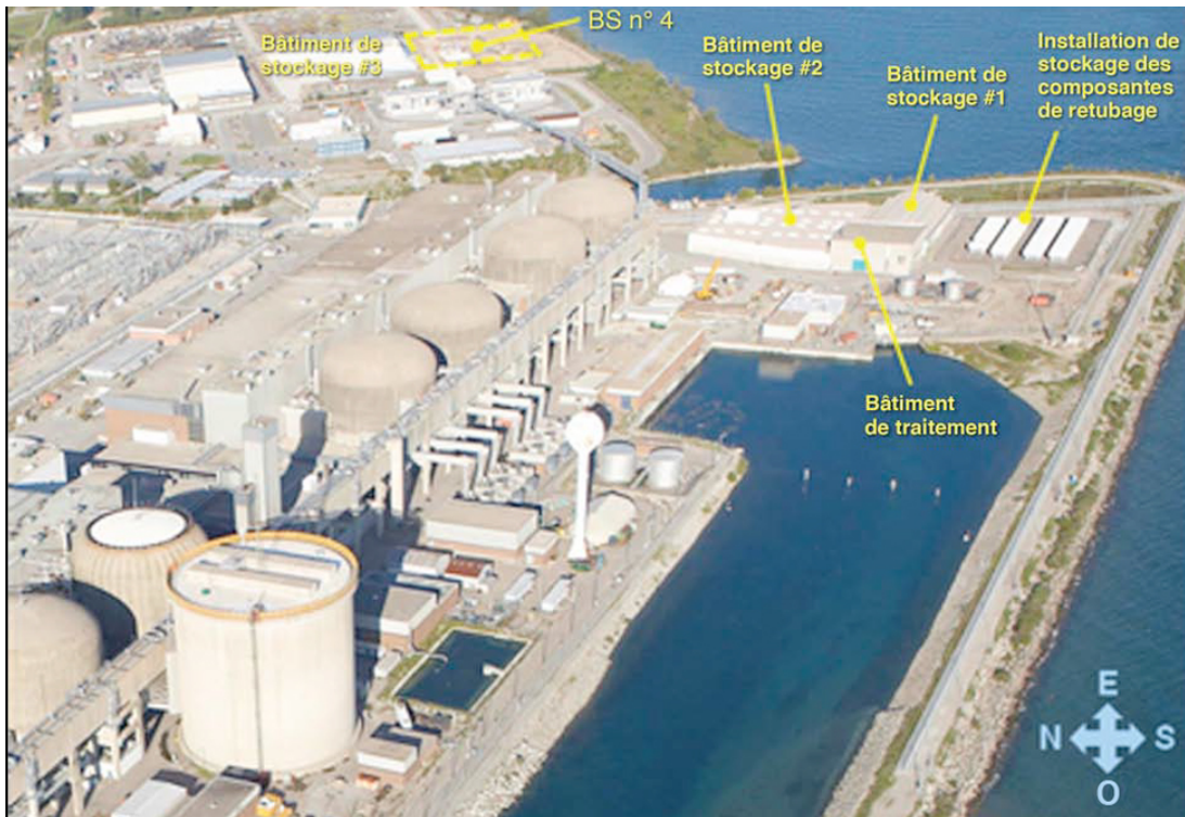
Figure 4.5 – Aire de l'IGDP I (bâtiment de traitement, bâtiments de stockage 1 et 2, et installation de stockage des composants de retubage) et de l'IGDP II (bâtiment de stockage 3 et bâtiment de stockage 4 prévu)
