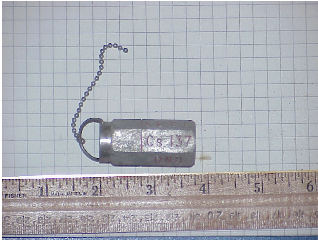
Figure J.1 : Source radioactive scellée de césium 137
