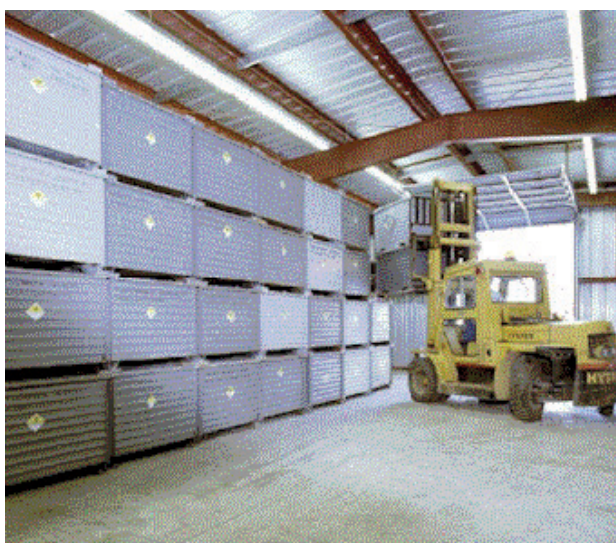
Figure 5.8 – Structures de stockage modulaire en surface dans la zone de gestion des déchets H
