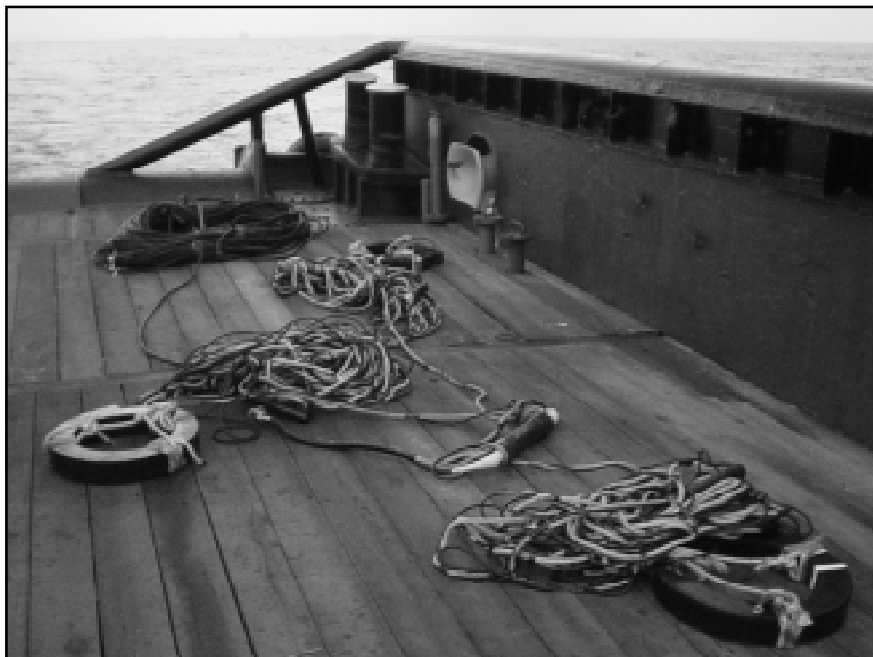
Capteurs et câbles sur l'arrière de la plate-forme après une opération de démagnétisation réussie.
