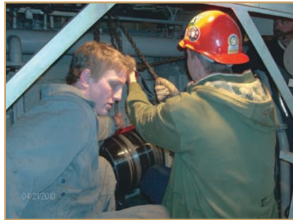
Étape 8. L'apprenti en mécanique de l'IMFCS Jake VanRossum (à gauche) et le monteur de l'IMFCS Justin Burke posent le nouvel embrayage de 265 kg en place.
