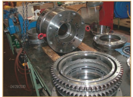
Étape 9. L'embrayage partiellement désassemblé repose sur l'établi aux fins d'inspection visuelle à l'IMFCS.
