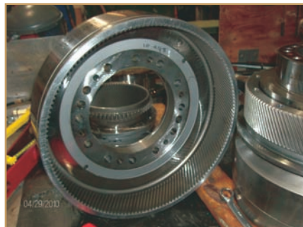
Étape 11. L'ensemble d'entrée (déposé dans l'illustration de l'ensemble coulissant principal) est aussi exempt de défaut.
