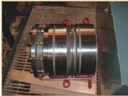
Étape 7. L'embrayage de rechange doté de ses supports de transport.
