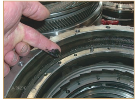
Étape 12. Une accumulation importante de boue à certains endroits indique l'emplacement où les contaminants se sont accumulés pendant la durée de vie de l'embrayage, et pourrait également être liée à ce bruit problématique de l'embrayage.
