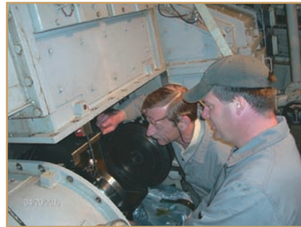
Étape 5. L'ajusteur en mécanique de l'IMFCS, Jim Rankin (à l'avant-plan), et l'auteur Bob Steeb vérifient les lectures de déviation de la bride.
