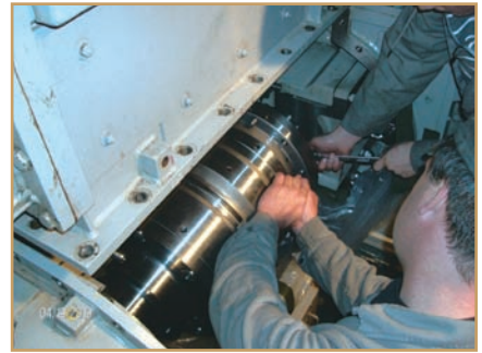
Étape 3. L'embrayage exposé est désaccouplé.
