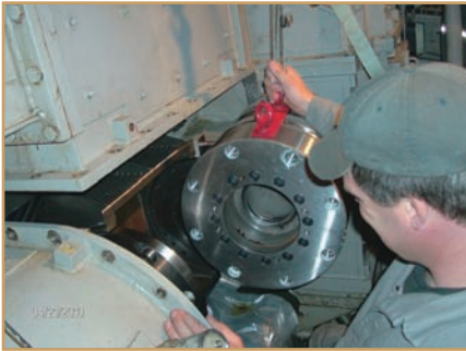
Étape 4. L'embrayage exposé est soulevé à l'aide d'un support de transport simple.
