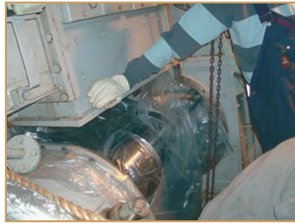
Étape 2. La section de la boîte de vitesses est déposée.
