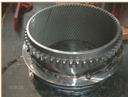
Étape 10. L'ensemble coulissant du relais est exempt de défaut.
