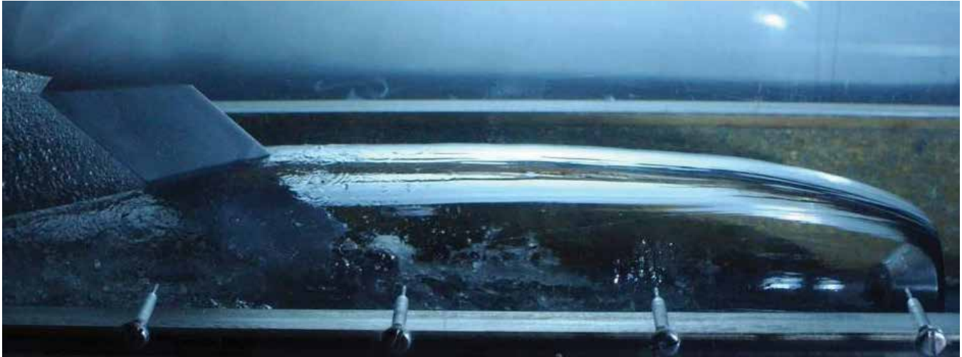
Figure 3 – La commande d'un corps à supercavitation est un exercice complexe en aérodynamique à l'intérieur de la cavité gazeuse et en hydrodynamique dans l'eau de mer environnante. (Source : http://cav.safl.umn.edu/gallery.htm )
