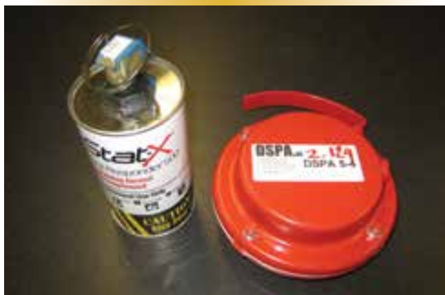
Figure 1 – On a mis à l'essai deux variantes d'extincteurs en aérosol à activation manuelle avec des incendies en vraie grandeur et en milieu réel au laboratoire de recherche sur les incendies de l'Université de Waterloo (UW), soit le First Responder ® de StatX (à gauche) et le Manual Firefighter ® de DSPA.
