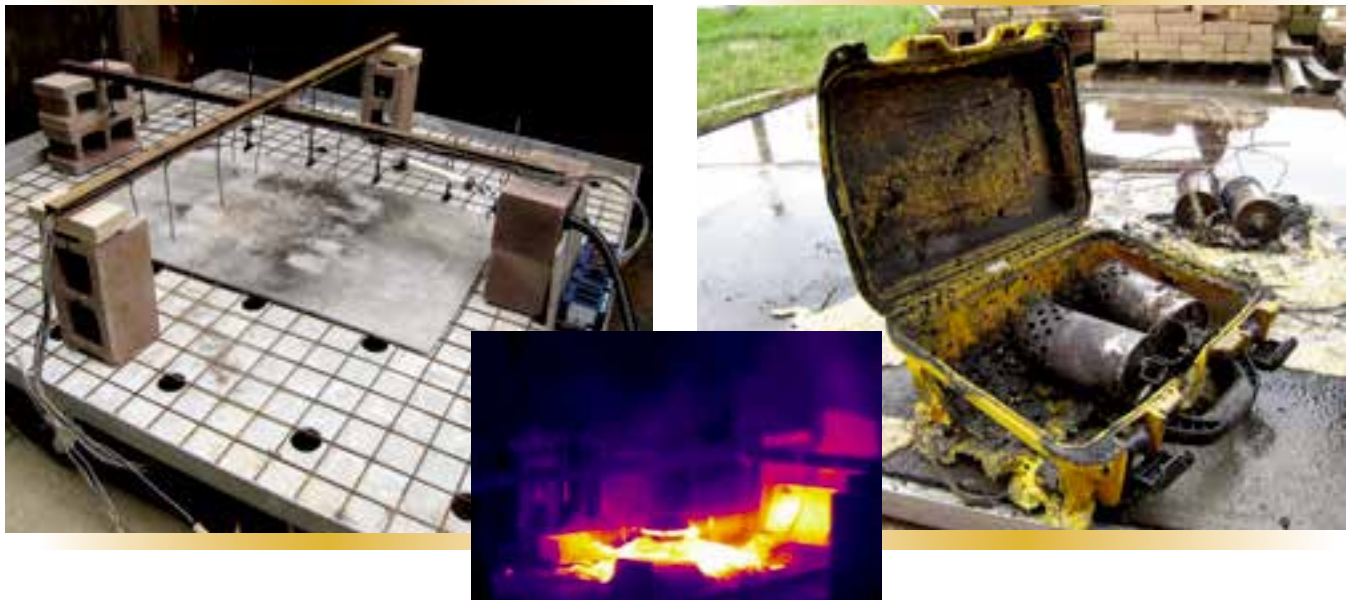
Figure 5 – Pour faire l'essai d'une décharge accidentelle des extincteurs en aérosol à l'intérieur d'une boîte de rangement fournie par le fabricant, on a installé des thermocouples sur les boîtes et on les a déposées sous un banc d'essai personnalisé afin de mesurer le rayon de chaleur après l'activation d'un dispositif. Tant pour les dispositifs de DSPA que de StatX (photos en médaillon), les boîtes ont tenu le coup malgré des températures internes atteignant les 800 °C.
