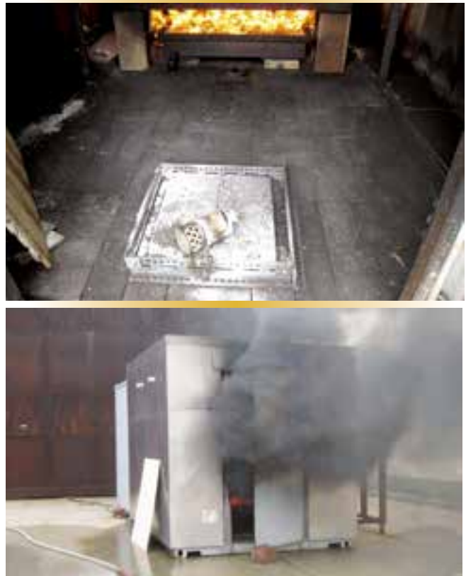
Figure 3 – Une salle de simulation d'incendies isolée, construite à l'intérieur de ce conteneur de transport ISO a permis de simuler de façon satisfaisante un incendie dans un petit compartiment machines et de mesurer l'efficacité d'un petit extincteur en aérosol (image) dans ce compartiment.
