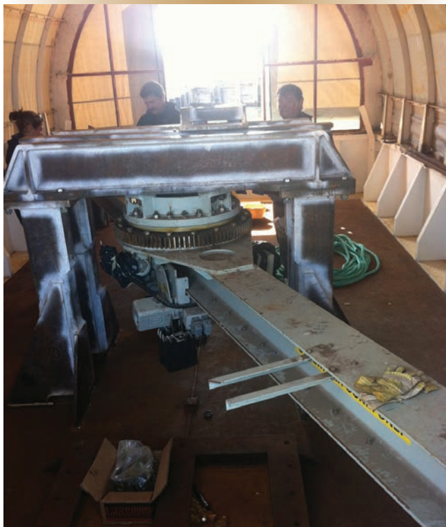
Figure 2. La grue du PHM était reliée à un dispositif d'essai spécialement fabriqué et relié à un pont muni d'instruments avant d'être installée à bord de la plate-forme flottante d'essais de résistance aux chocs du CETM.
