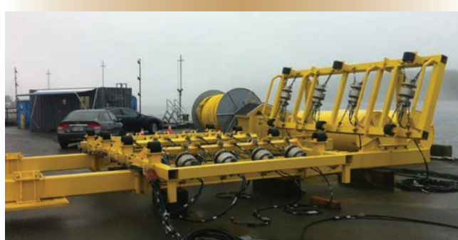
Figure 3. L'ensemble de canons à air déposé sur la jetée à Shearwater, à l'extrémité sud du port d'Halifax. L'utilisation de la technologie des canons à air au lieu d'explosifs traditionnels constituait une première pour le MDN dans le cadre d'essais de résistance aux chocs de matériels lourds avec un équipement en service, mais la technologie en soi avait fait l'objet d'essais en 2009 en utilisant un sous-marin hors service en tant que sujet.
