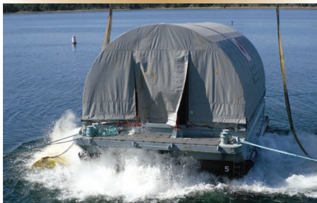
Figure 4. La plate-forme flottante transportant la grue et le dispositif de soutien réagit à un tir d'essai provenant du réseau de canon à air submergé.
