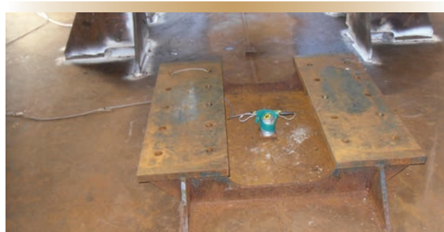
Figure 5. Les accéléromètres fixés au support de grue (à gauche) et à la plate-forme en acier du dispositif de simulation de pont DSP II ont transmis des données confirmant la réussite des essais de résistance aux chocs de matériels lourds.
