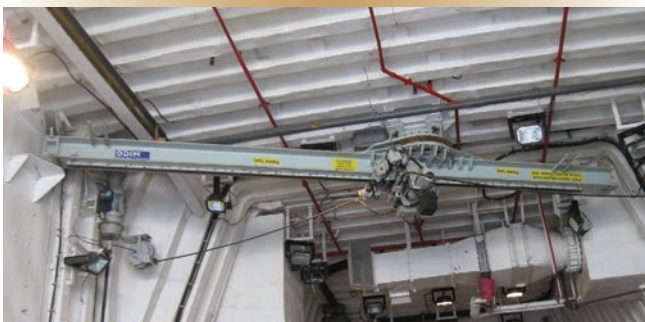
Figure 1. La grue du PHM comme on la voit dans le hangar à bord du NCSM Montréal . Le navire était la frégate choisie pour les essais de réception du Projet des hélicoptères maritimes.
