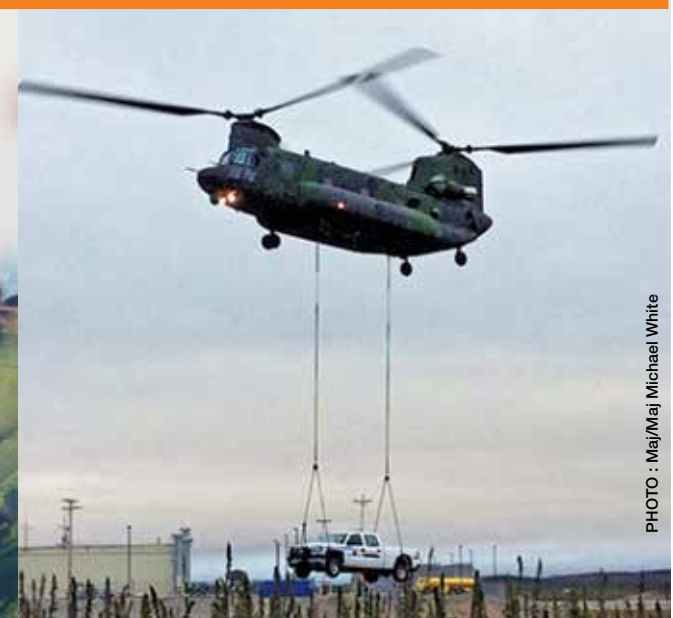
CAF members sling a RCMP truck beneath a CH-147 Chinook helicopter for transport from Tuktoyaktuk to INUVIK Mike Zubko Airport. Des membres des FAC hissent un camion de la GRC à l'aide du treuil d'un hélicoptère CH 147 Chinook pour le transporter de Tuktoyaktuk jusqu'à l'aéroport Mike Zubko d'Inuvik.
