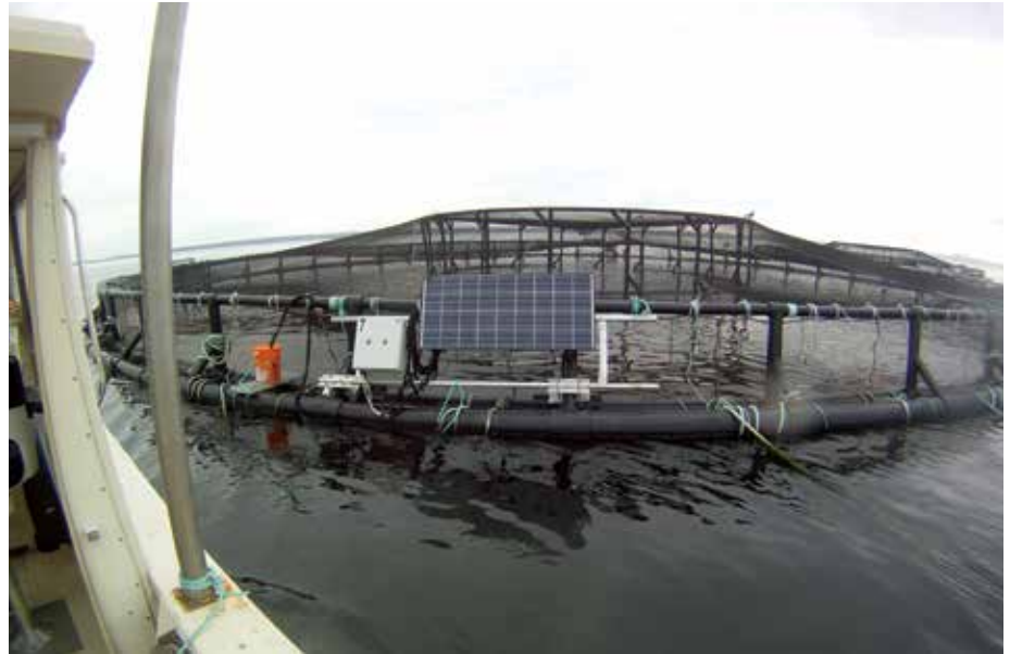
Piège lumineux pour le pou du poisson fonctionnant à l'énergie solaire et attaché à une cage à saumon dans la baie de Fundy. Photo : Nathaniel Feindel (MPO)
