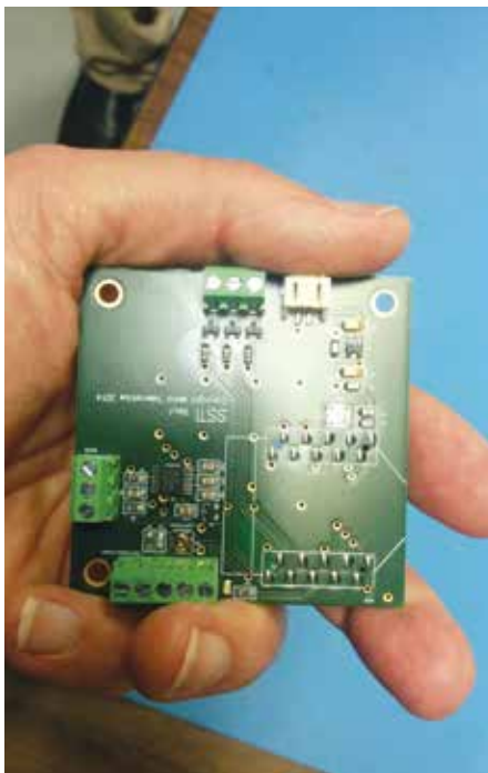
Carte mère personnalisée conçue pour commander le profiteur muni d'un treuil, les divers capteurs de la qualité de l'eau et la télémesure du système. Photo : Steve Morgan
