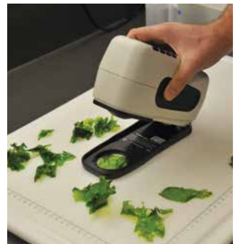
La couleur de fragments de l'algue verte, Ulva lactuca , est analysée à l'aide d'un spectromètre de couleur portable afin de quantifier les nutriments dissous. Photo : Andrew Cooper (MPO)
