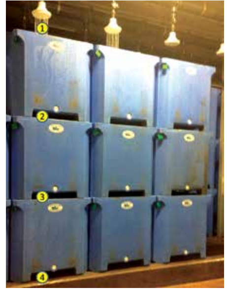
Réservoirs de stockage de moules vivantes empilés. De l'eau est introduite au sommet, puis percole jusqu'au bas du réservoir. Les emplacements d'échantillonnage de l'eau sont indiqués par les cercles jaunes numérotés. Photo : Daniel Bourque (MPO)
