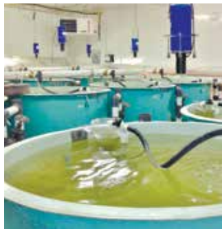
Unités d'élevage en forme de cône munies de bouteilles d'incubation et de distributeurs alimentaires vibrants suspendus au-dessus. Photo : Station piscicole du lac White (MRNFO)
