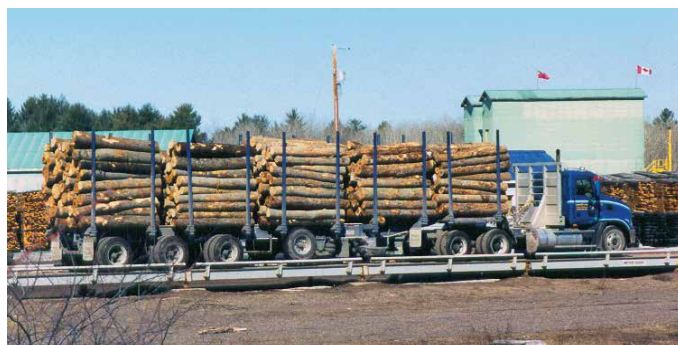
Camion chargé de billes sur une balance. On calcule la masse du chargement en soustrayant le poids du camion.
