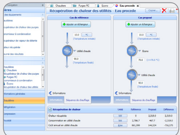
Comparaison de la récupération de chaleur des systèmes utilitaires pour une situation existante et une situation modifiée
