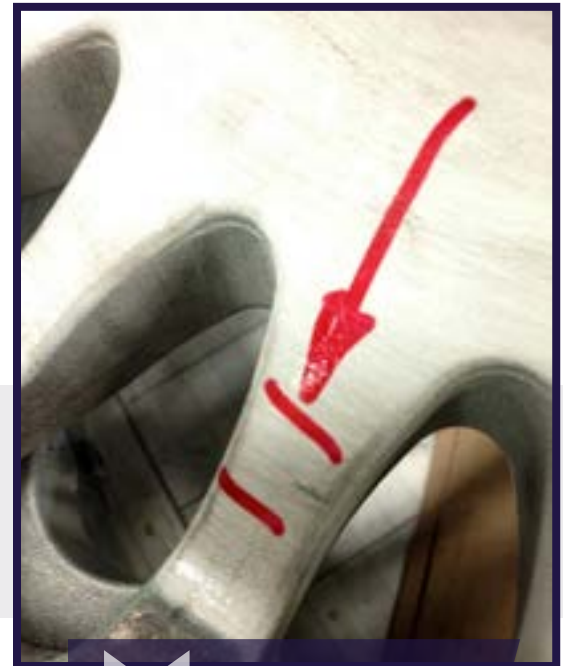
Demi-roue avec rayon fissuré
