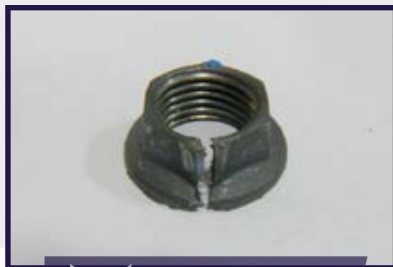
Écrou NAS 12917 fissuré
