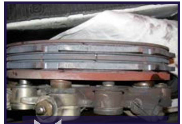
Bloc frein retiré en raison d'une usure excessive
