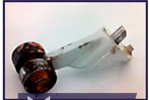
Rupture du boulon de la masse d'équilibrage du rotor de queue
