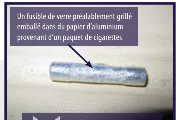
Modification non approuvée d'un fusible
