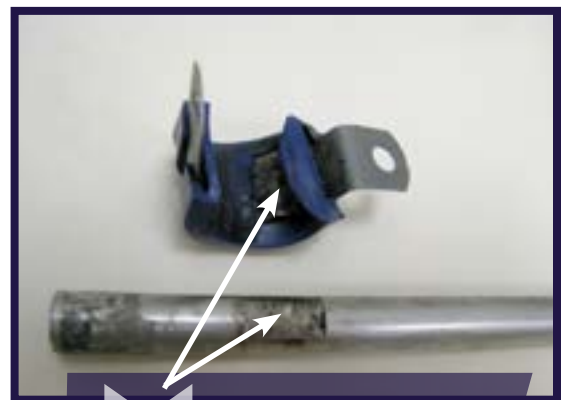
Conduite hydraulique usée par frottement et manchon usé de la bride
