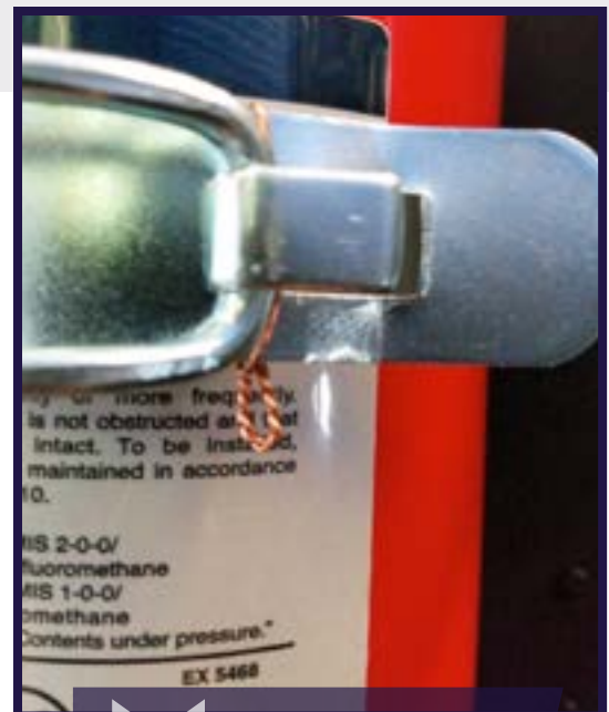
Nouveau fil témoin installé comme recommandé dans le BSA 429-14-14
