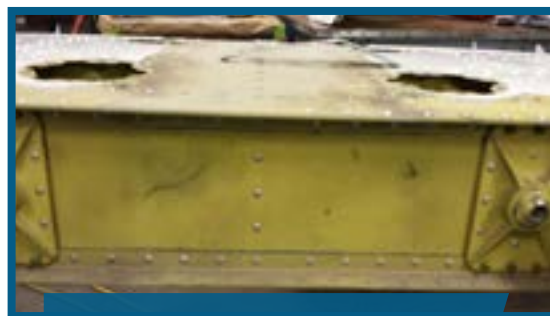
Fissures sur le longeron arrière du stabilisateur
