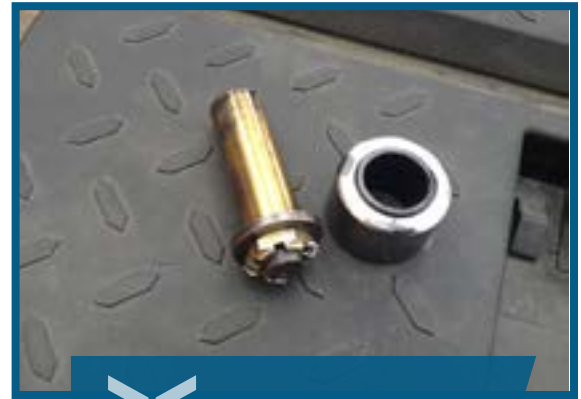
Axe dégagé et roulement situé dans le moyeu de l'hélice
