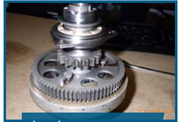
Ensemble arbre d'engrenage droit avec boulons desserrés et rondelles freins d'écrou manquantes
