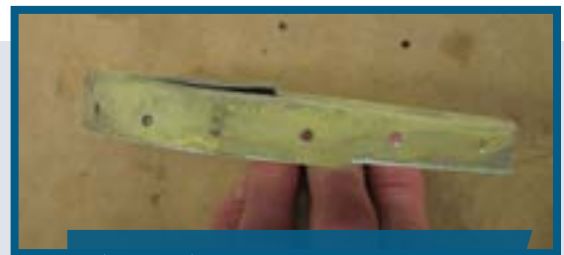
Vue de haut de la nervure fissurée
