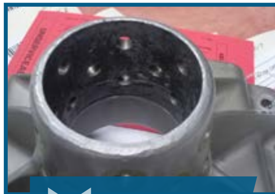
Raccord de l'arbre de conjugaison du gouvernail de direction fissuré
