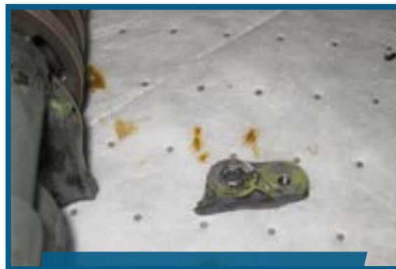
Bride de pompe à huile principale rompue
