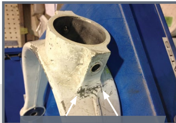
Vue de la fissure sur la fourche du train d'atterrissage avant
