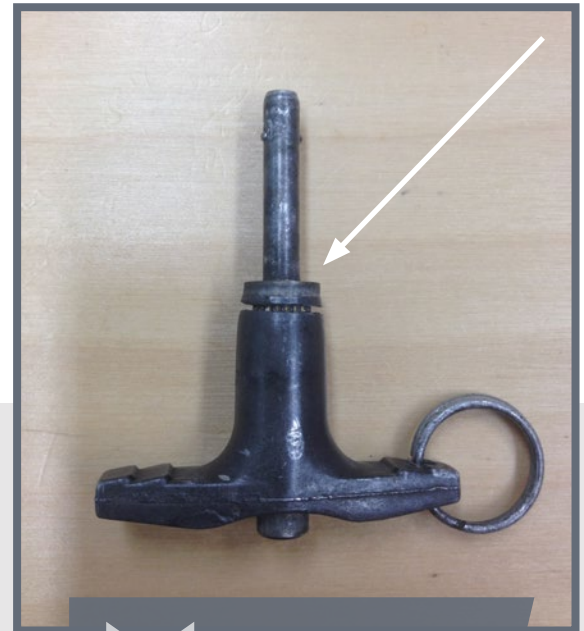
Fissure sur la poignée de déclenchement en T, no de pièce 204-072-727-013
