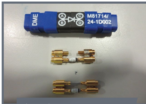
Vue de la diode utilisable et de la diode court circuitée
