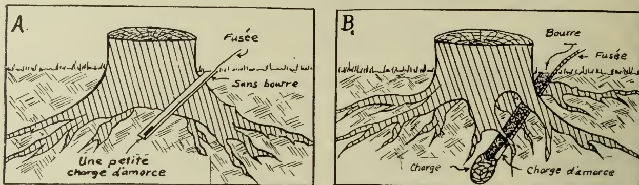
Fig. 17.—La bonne manière de placer les explosifs—Une petite charge d'explosifs peut être placée sous la souche (A) pour faire un trou pour une charge plus lourde. L'illustration (B) montre une charge complète en place.
