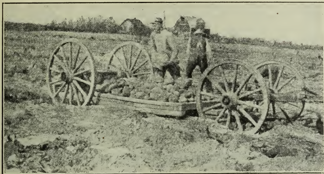
Fig. 20.—Voiture domestique à basse suspension pour l'épierrage—Les voitures à basse suspension peuvent être chargées facilement et sont plus satisfaisantes pour le débardage des pierres que les traîneaux à pierres lorsque la distance de débardage est supérieure à de 150 à 200 pieds. (Photo reproduite du Bulletin n° 250 de l'Université du Minnesota.)
