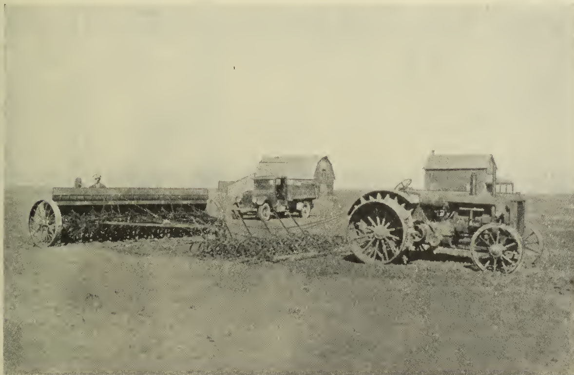
Une combinaison qui permet à un seul homme d'ensemencer 50 acres de terre en jachère d'été par jour.
