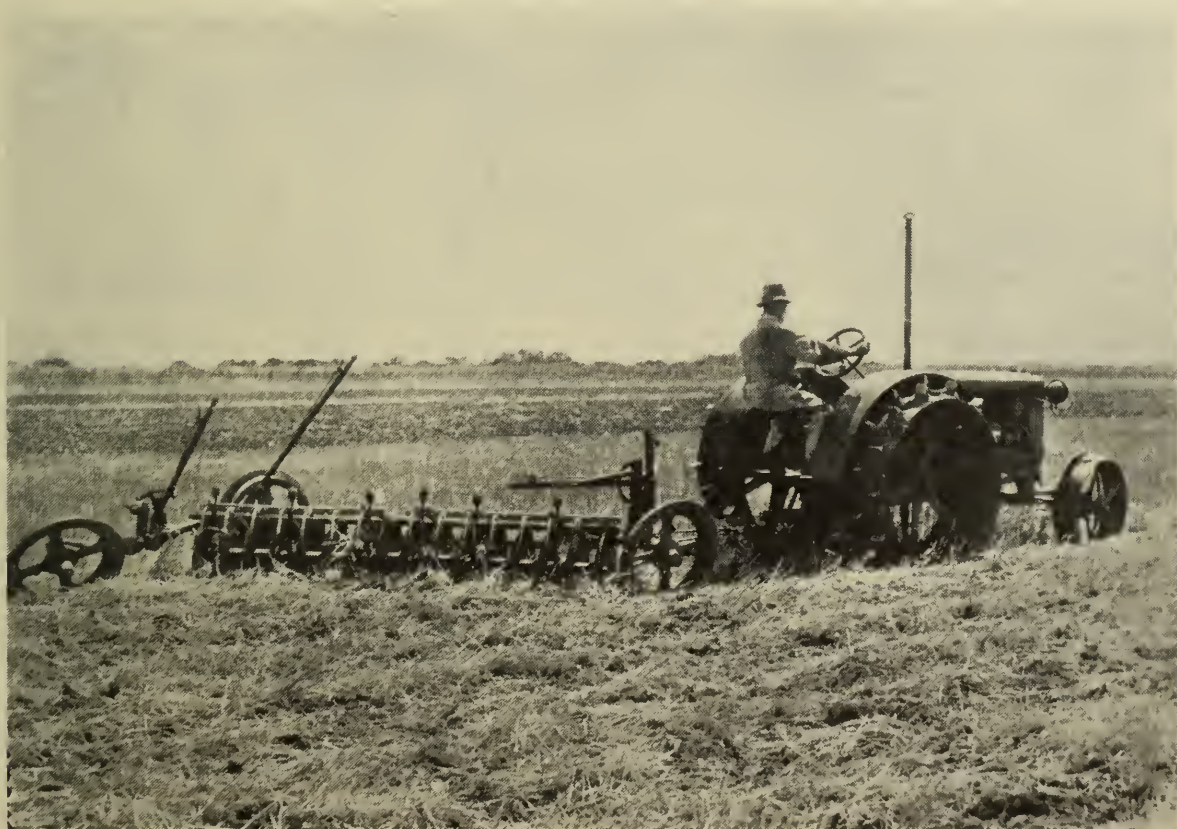
La charrue à disques ou "disque à sens unique" ( one way disk ) peut être employée pour accélérer les opérations sur chaume et jachère d'été. Une machine de neuf pieds couvre trois acres par heure.
