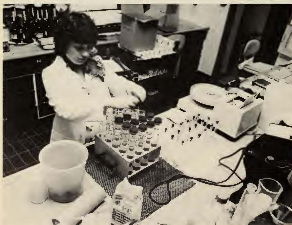
Micheline Pelletier, technicienne, détermine la teneur en NPK du maïs. *Micheline Pelletier, technician, determining the NPK content of corn.*
