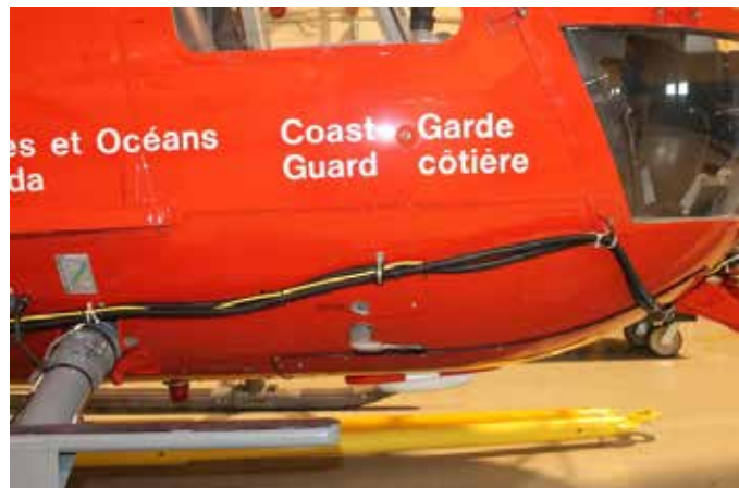
Photo 4. Exemple d'acheminement du faisceau de câbles en août 2013
