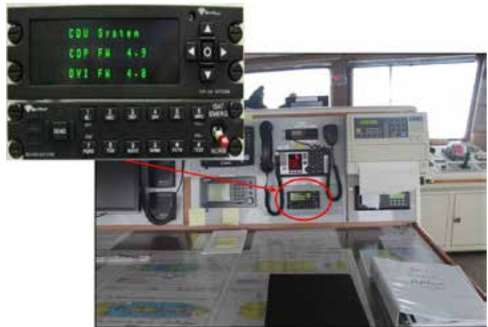
Figure 10. Emplacement de l'interface utilisateur CDU-300 du SSV à la table des cartes
