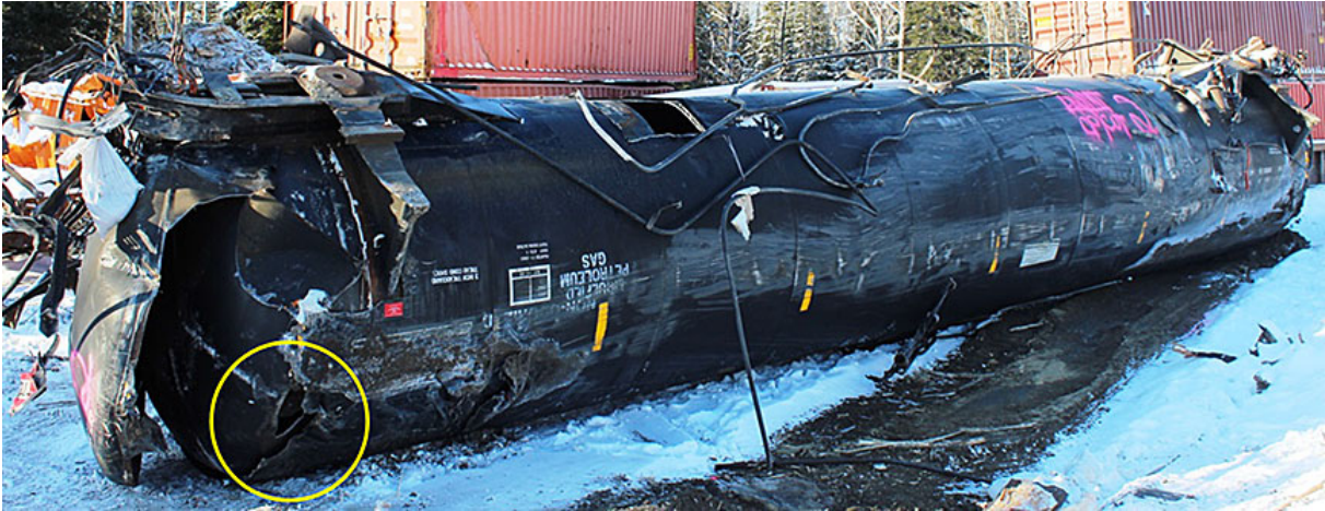
Photo 5. Perforation du wagon-citerne GATX 200483
