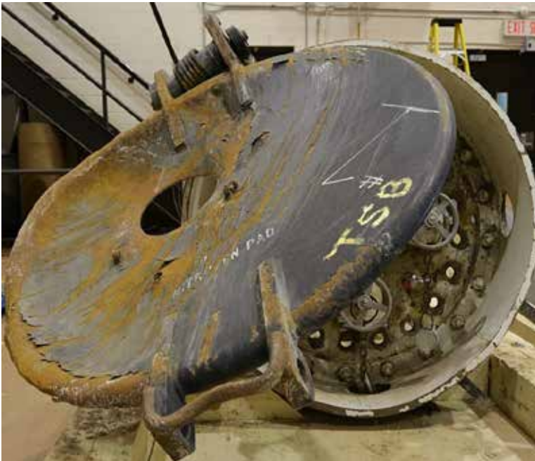
Photo 4. Enceinte protectrice et couvercle du wagon PROX 36178
