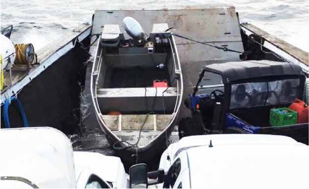
Photo 3. Eau s'infiltrant à bord du Lasqueti Daughters par la rampe d'étrave
