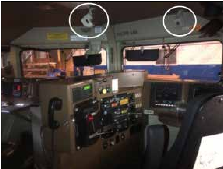
Figure E3. Chemin de fer B : Emplacement des caméras au plafond de la cabine (cercles blancs) (Source : Chemin de fer B)
