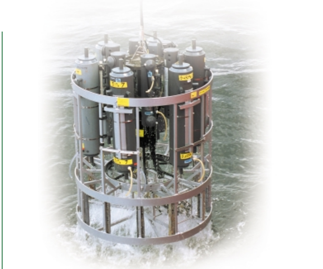
Appareil appelé « rosette », servant à prélever des échantillons d'eau de mer à différentes profondeurs
