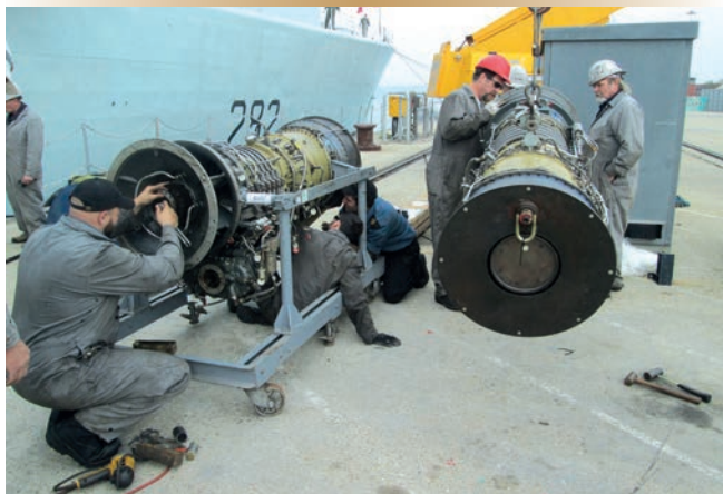
Figure 6. Échange des raccords entre l'ancien moteur et le nouveau.
