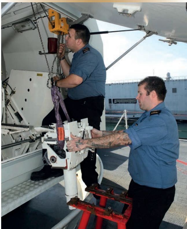
Une préparation minutieuse, la clé de la réussite. Les techniciens en génie des armes retirent le refouloir (à gauche) et la photomitrailleuse (à droite).
