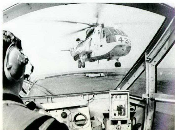
“Un des membres de l'équipe du pont d'envol met ce fil à la masse du navire et le fixe au câble du hale-bas, ...”
