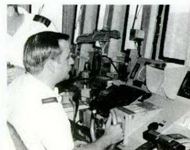
La commande des gaz, située sur la passerelle, est réglée à la vitesse désirée.
